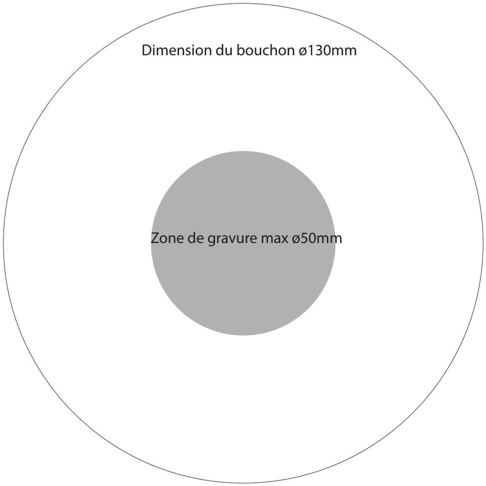
Dimension du bouchon  $\varnothing 130\text{mm}$
